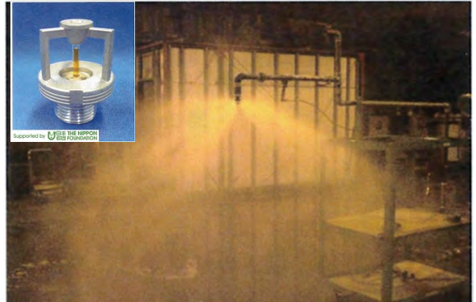
〈マイクロフォグ（微細噴霧化）スプリンクラーヘッドの開発〉
